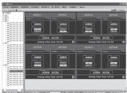
i-MASTER 通过集中控制界面来同时对多个功能模块进行状态监控。用户可随意加减控制界面的数量。模块控制界面窗口的大小和位置可随意调整，关闭窗口时自动保存模块窗口的位置和大小。
