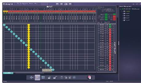
X-Array提供灵活的组态监控方式来有效的整合与矩阵连接的设备,可自由编辑组合和集成所关心的设备的信号路径,可在不关心矩阵路由的条件下,通过图形化方式完成设备之间的信号路由配置。
