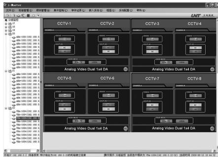
i-MASTER通过集中控制界面来同时对多个功能模块进行状态监控。用户可随意加减控制界面的数量。模块控制界面窗口的大小和位置可随意调整，关闭窗口时自动保存模块窗口的位置和大小。
