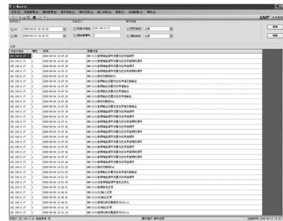
i-MASTER通过事件记录界面来提供i-MOD设备的报警和状态变化记录的查询接口。通过事件发生时间、设备地址、事件类型的设置来对事件记录进行筛选。系统自动保存最近一年内所有的记录信息。
