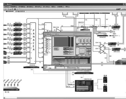
i-MASTER可以在系统框图中链接各功能模块或设备（包括第三方）的控制组件。通过激活相应的控制组件来打开对应各功能模块或设备的控制界面或控制软件（包括第三方）。用户可以在他们熟悉的系统框图中完成其中各功能模块和设备的控制。
